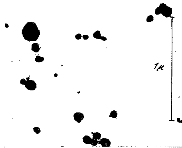
Abb. 8. Kolloides Silber. Einzelne Teilchen erscheinen deutlich sechseckig oder dreieckig. Die Kristallform des Silbers ist das Oktaeder, wobei die sechseckig erscheinenden Teilchen vollständig ausgebildete Kristalle darstellen, während die dreieckigen Exemplare Formen haben, die im Modell entstehen, wenn von einem vollständigen Oktaeder ein Teil durch einen nahe einer Dreiecksfläche parallel zu dieser geführten Schnitt abgetrennt wird. El.-opt. 30 000:1.
