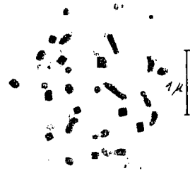
Abb. 13. Zigarrenrauch. Nadel-förmige, an ihrer Umrandung noch erkennbare Rauchteilchen sind flüchtig geworden. El.-opt. 13000:1.
